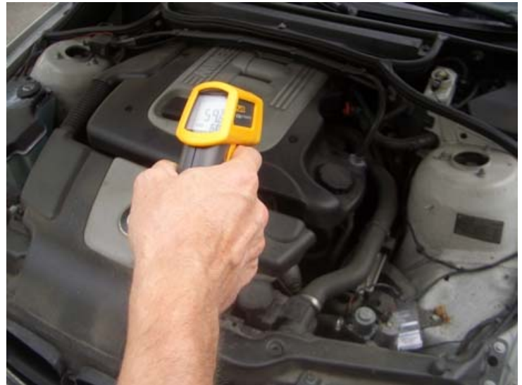
Temperaturmessung im Automotor mit dem Pyrometer
